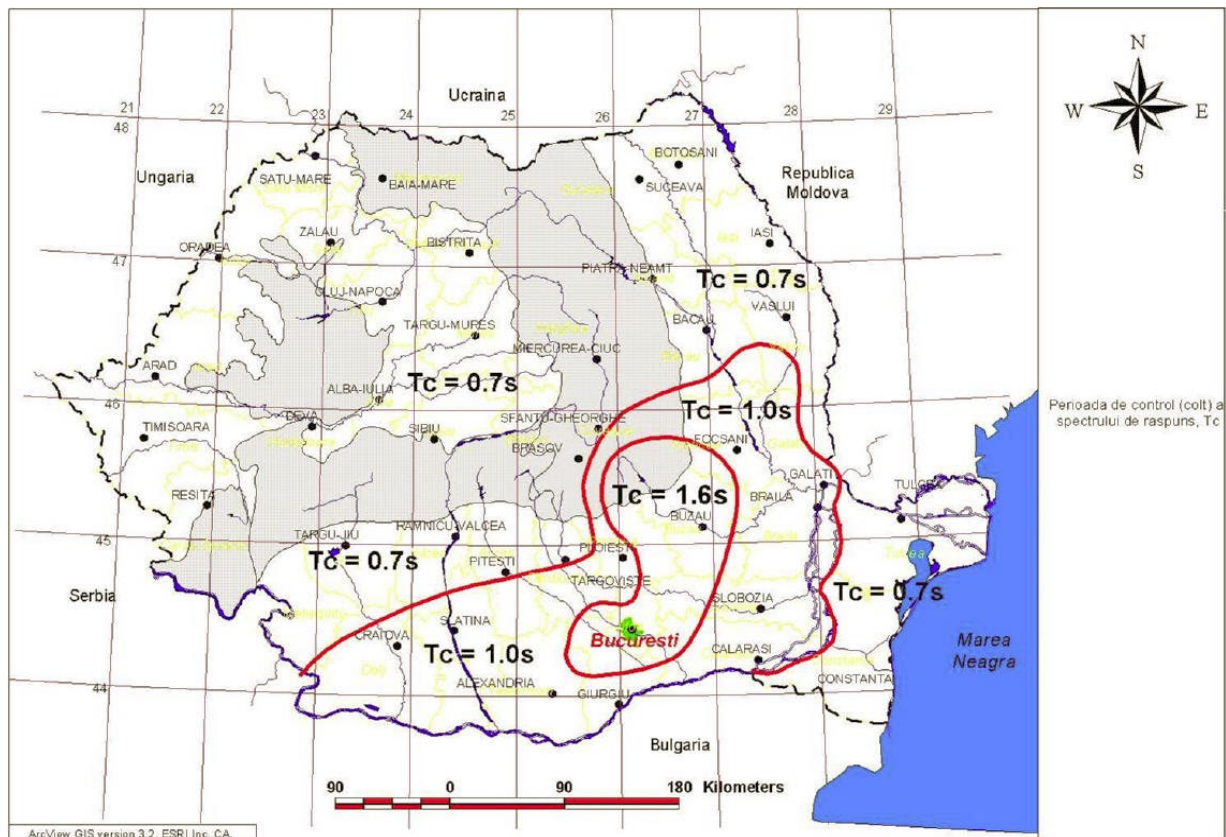
Figura 2-4 - Zonarea teritoriului Romaniei in termeni de perioada de control (colt), T_c , a spectrului de raspuns
